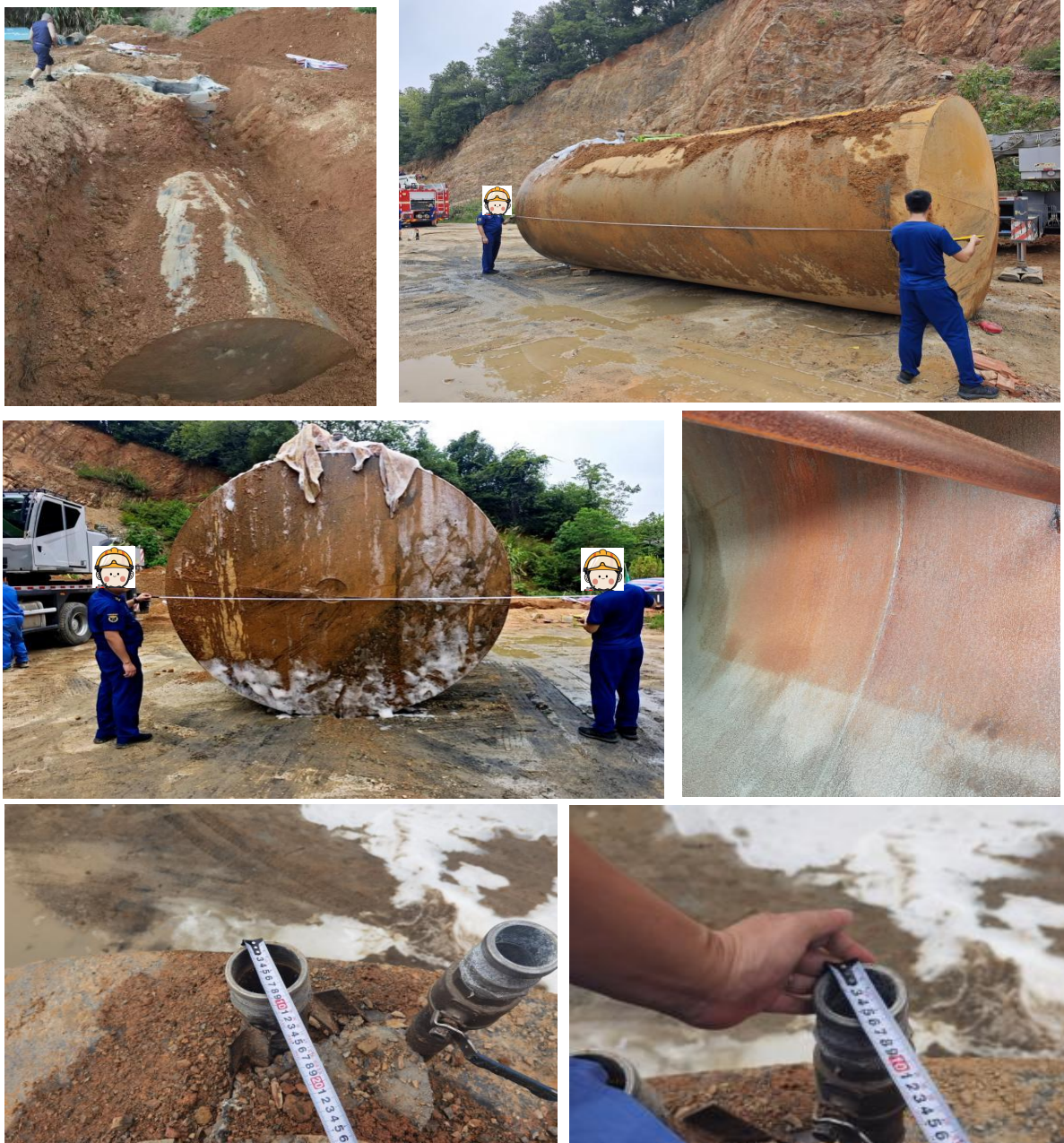
图 11 储罐外部尺寸情况
