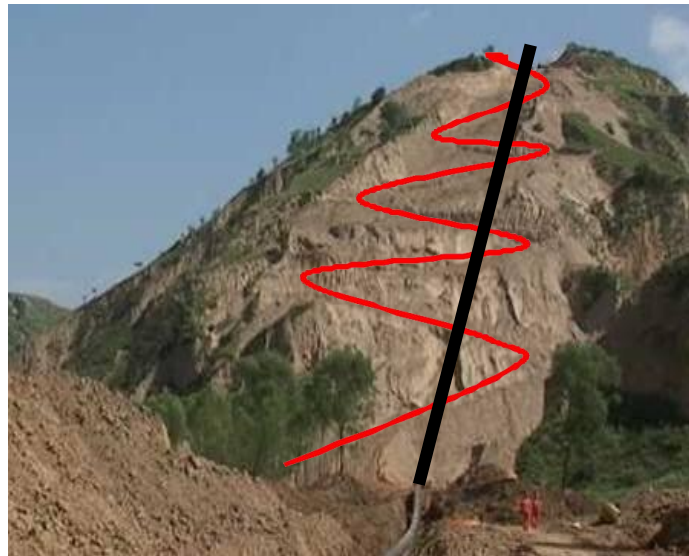
图 2-4 修筑之字路绕行便道施工示意图
