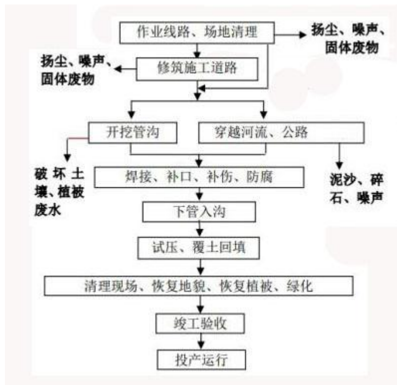
图 2-8 管道施工流程及产污节点示意图
