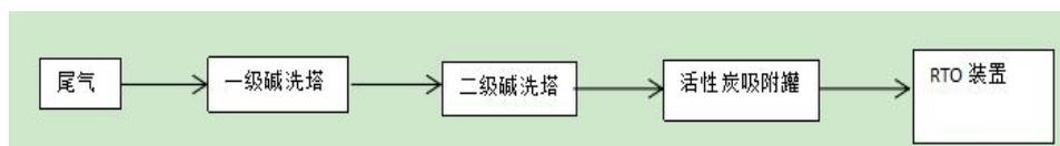
图 4-1 依托恶臭处理装置工艺流程图
